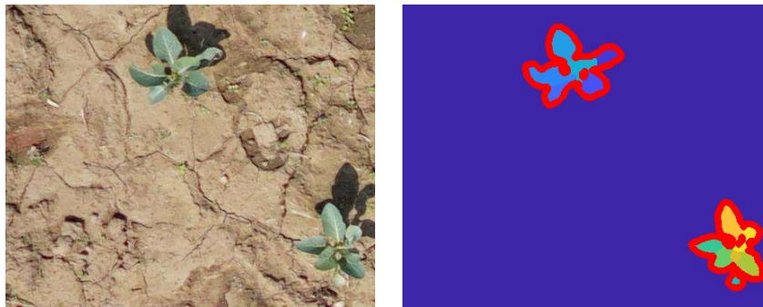
Abbildung B3: Beispielhafte Annotation eines aus dem in AP1 erstellten Orthophotos extrahierten Bildes. Lila entspricht hierbei den Bodenpixeln, rot den Begrenzungen einer Pflanzeninstanz und die weiteren Farben geben die verschiedenen Blattinstanzen wieder. Alle farblich markierten Blätter innerhalb einer roten Umrandung gehören zu derselben Pflanzeninstanz. © OPTIKO
